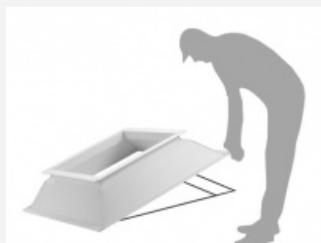
1. Presentar el zócalo sobre el hueco del forjado.
