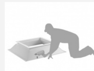
2. Fijar el zócalo a la cubierta con tirafondos (no incluidos).
