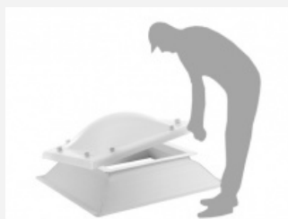
4. Presentar la cúpula sobre el zócalo, centrar y marcar los agujeros en el zócalo y retirar la cúpula. Taladrar el zócalo con broca de hierro de 5 mm.
