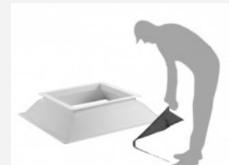
3. Cubrir toda la parte exterior del zócalo con lámina impermeable.
