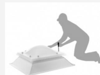
5. Montar la cúpula sobre el zócalo, sin apretar excesivamente los tornillos para evitar el riesgo de rotura de la cúpula o anular el efecto de la arandela de dilatación.
