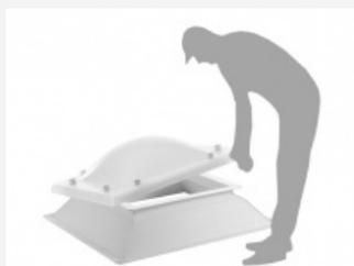
4. Presentar la cúpula sobre el zócalo, centrar y marcar los agujeros en el zócalo y retirar la cúpula. Taladrar el zócalo con broca de hierro de 5 mm.
