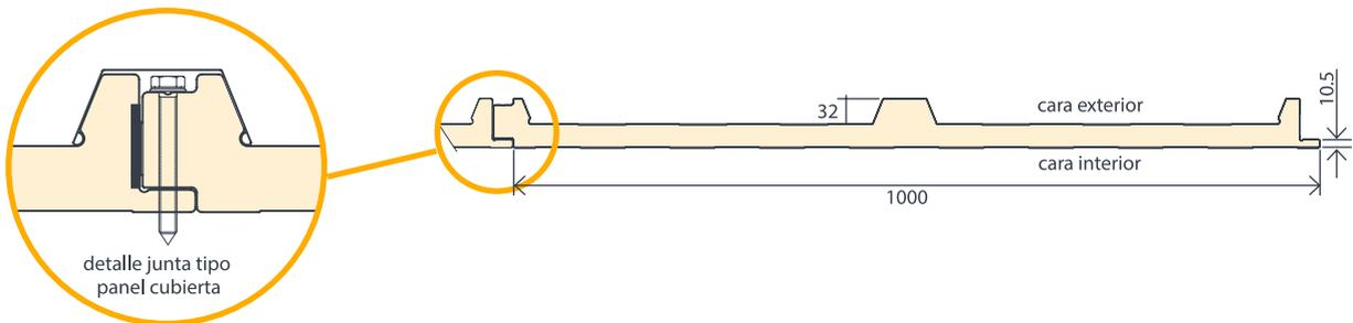
Fijación en panel con tornillo zincado long.min.=50 mm + espesor de panel (con arandela estampada).\*
